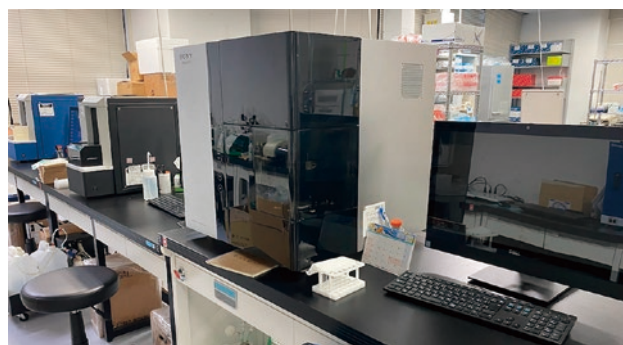
図2 抗体スクリーニングに使用するフローサイトメーター。研究室には4台の高速フローサイトメーターが常時稼働している。
